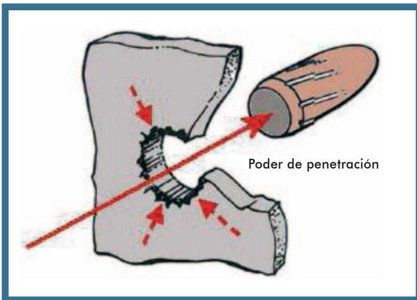
Un alto poder de penetración de una bala puede provocar un efecto llamado Soprenetración consistente en que la bala, después de alcanzar al objetivo aún conserve energía cinética como para atravesar al objetivo
